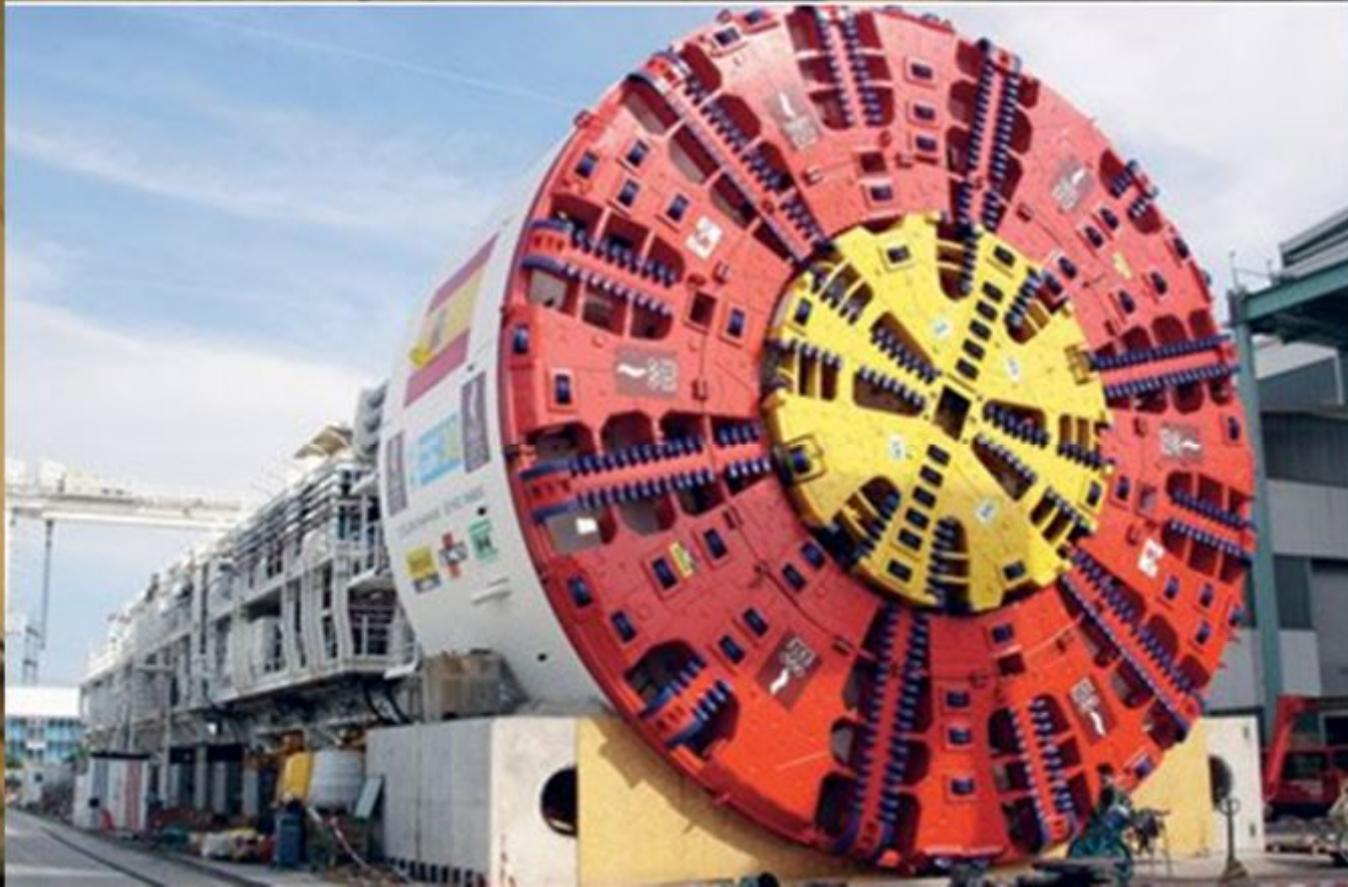
Tuneladora tipo EPB ( Earth Pressure Balance – Presión Equilibrada de tierras) 4.364 toneladas de peso, Longitud: 100 m (aprox.), Diámetro exterior: 15,20 m, Rendimiento máximo: 36 m/día
